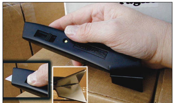
Der außergewöhnliche Safe-T-Cutter aus dem Hause X.I.P., für den Morris Technologies aus dem innovativem ProtoFunctional® Harz, DSM Somos® 9100, einen Prototyp erstellte. Das Harz wurde gewählt, da es die Zugfestigkeit und die Streckdehnung von Polypropylen nachbildet.
