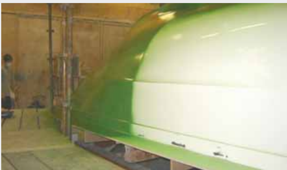
Pistolage de gelcoat chez Aquafibre
