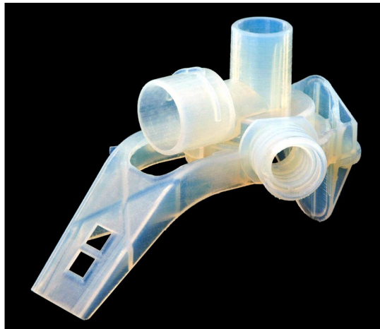
El prototipo del alojamiento de una bomba con válvula limitadora de presión al interior, proyecto para una lavadora de Maytag. Realizado por AMRCC en resina ProtoFunctional ® de DSM Somos ® , el prototipo de esta parte fue bastante robusto para ser instalado y ensayado directamente en una lavadora, permitiendo efectuar las modificaciones necesarias antes de completar las especificaciones del producto de serie.
