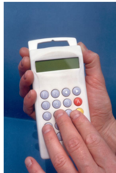
L'utilisation de la résine Somos® 7120 a permis d'effectuer directement sur les modèles de stéréolithographie les tests fonctionnels et de performance, ce qui a notamment permis de détecter un problème d'échauffement lors de l'utilisation et de le résoudre de façon optimale.
