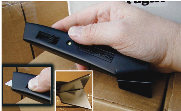
Le couteau utilitaire unique Safe-T-Cutter de X.I.P. Company, prototypé par Morris Technologies à l'aide d'une résine ProtoFunctional® nouvelle génération, DSM Somos® 9100, choisie parce qu'elle reproduit la résistance à la traction et le palier de limite élastique du polypropylène.
