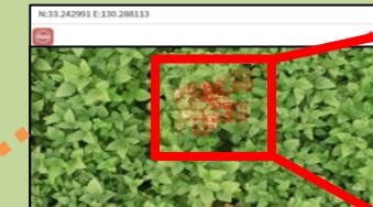
③自動飛行で害虫ポイントに到着。
